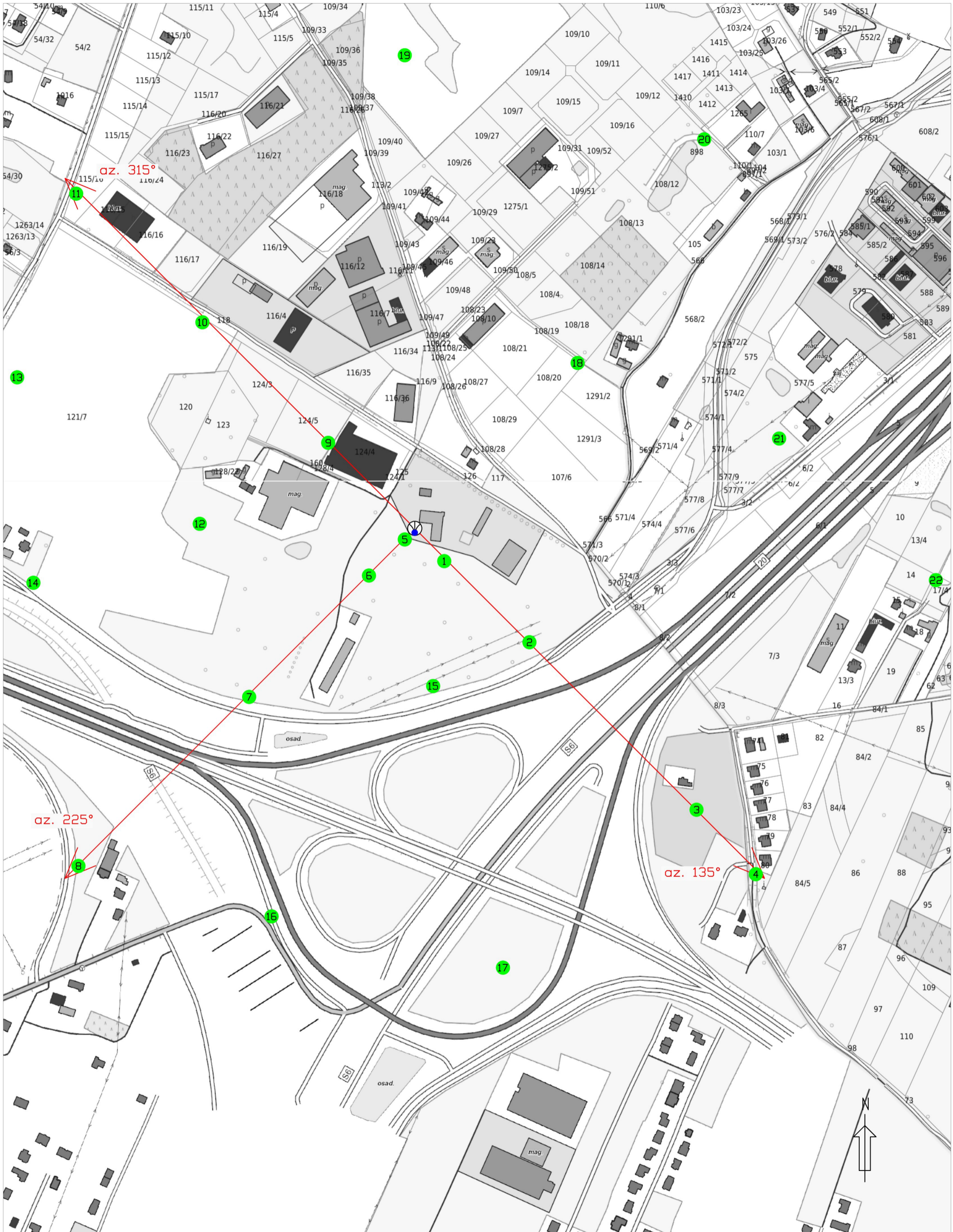
Rys.1 Lokalizacja pionów pomiarowych
