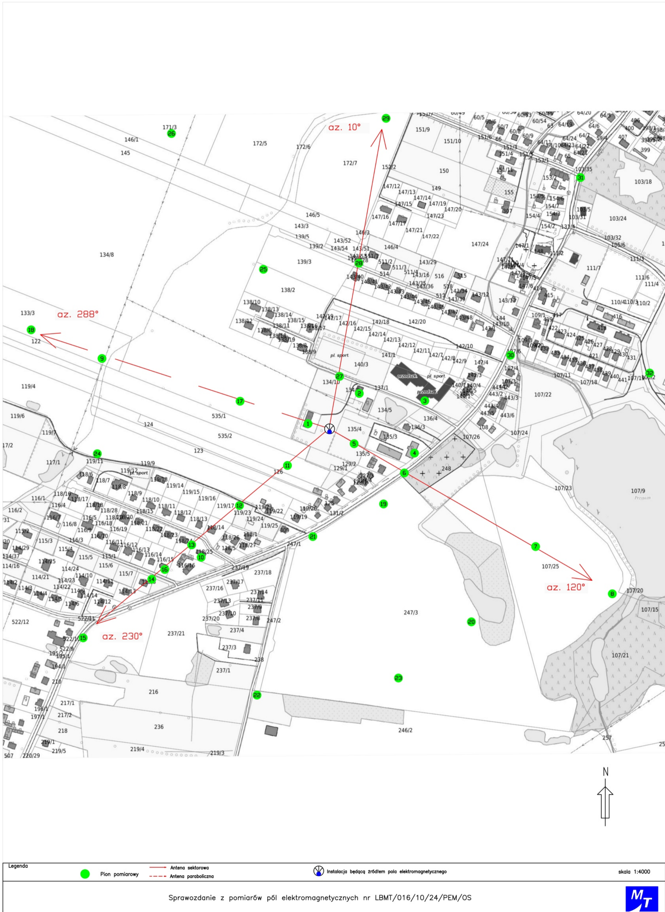
Rys.1 Lokalizacja pionów pomiarowych
